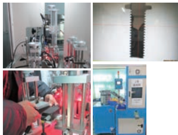
画像選別機 左上：全体 右上：画像 左下：カメラ調整の様子 右下：1号機
